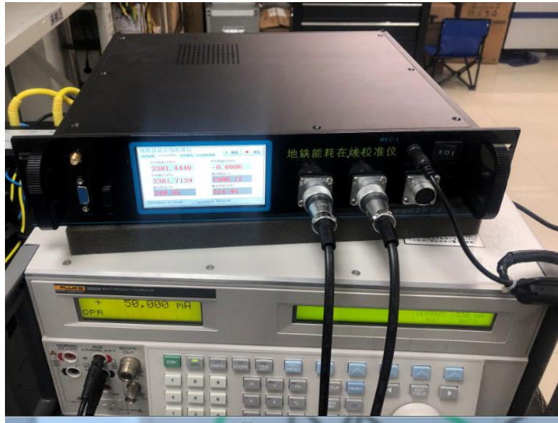
列车电压电流在线校准仪
