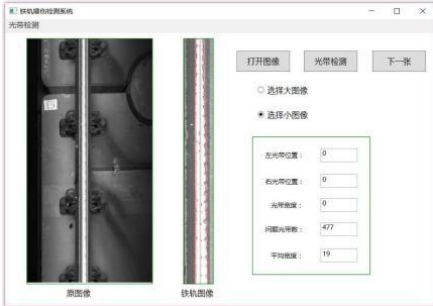
钢轨光带不匀检测算法示例
