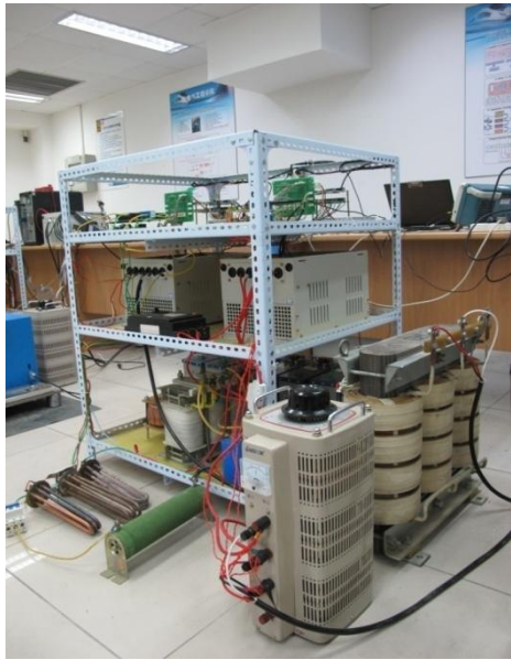
车载超级电容储能系统实验平台
