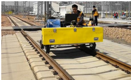
面向工务段基层的智能设备（智能巡轨车/巡轨箱）
