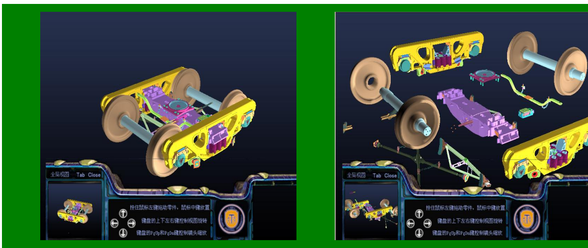
K6 转向架动态拆装系统（可进行 360 度旋转、缩放以及手动人机交互拆装）
