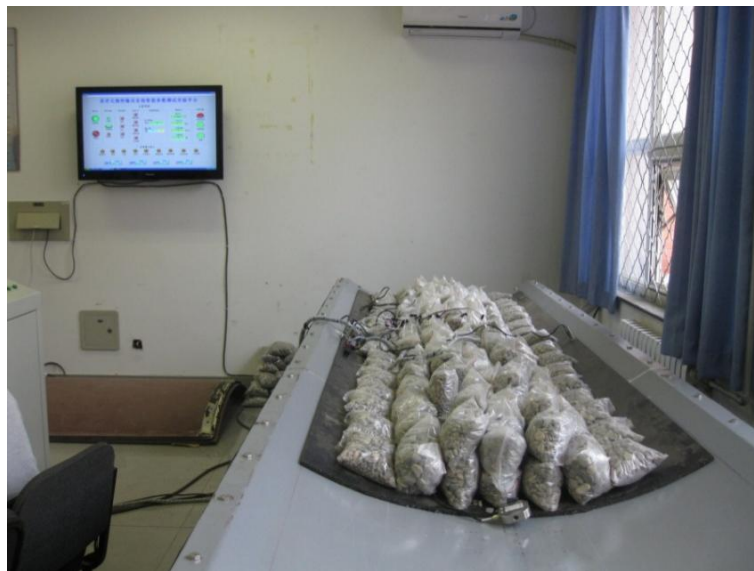
双气室串联结构实验平台
