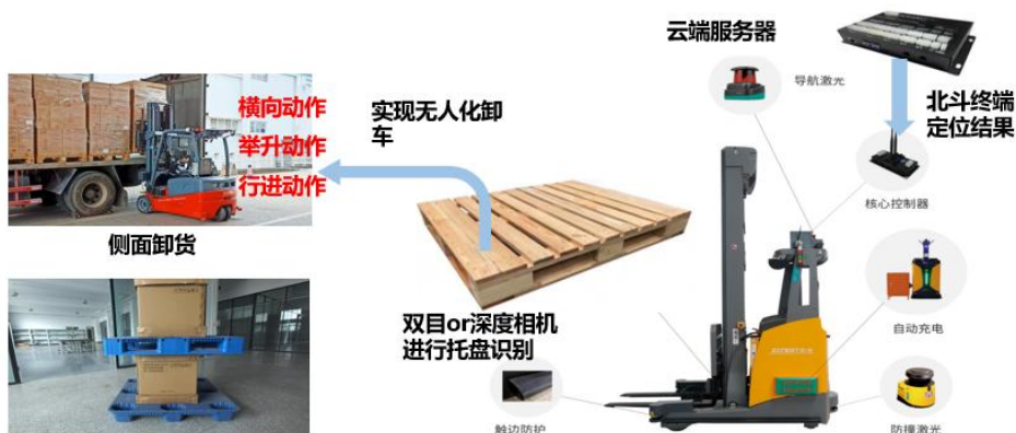
基于北斗定位技术与精准感知技术的新型无人叉车改造图
