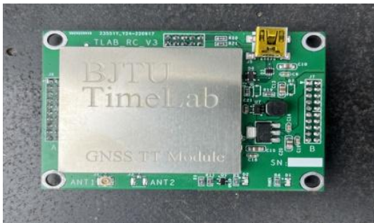
图 1 可定制的嵌入式 TLab-GNSS-G1 核心模块
