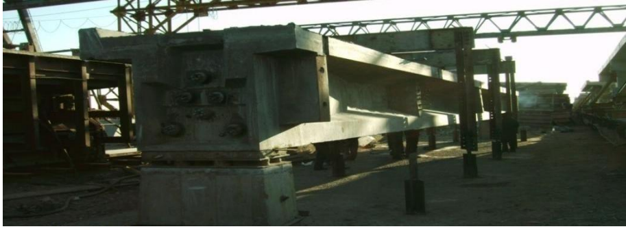
跨度 20m 低高度预应力活性粉末混凝土铁路简支梁静载实验
