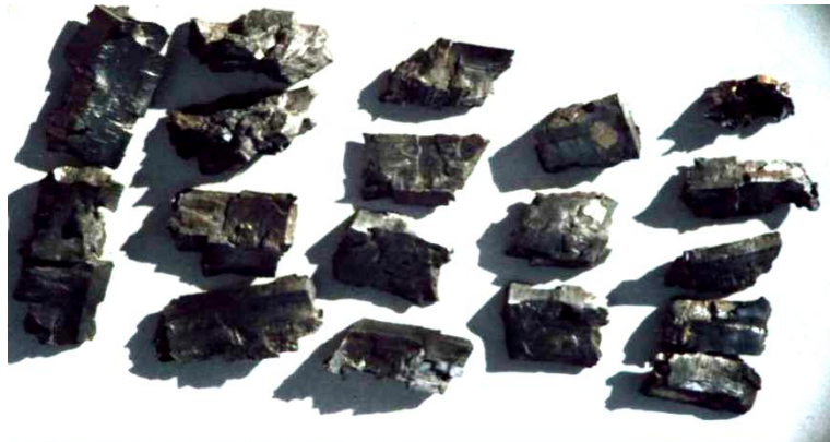
中碳贝氏体钢制造的预制破片炮弹打靶（厚铝板）及破片
