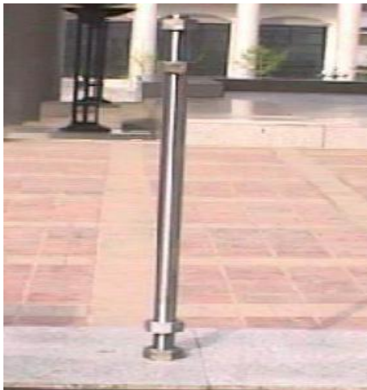
香港 9 号码头建设用贝氏体型 1500MPa 级大型螺栓 ( \phi 56 \times 1440 mm; \sigma_b : 1500MPa)
